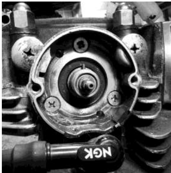
41.4A Druk de aandrijfpen op zijn plaats
