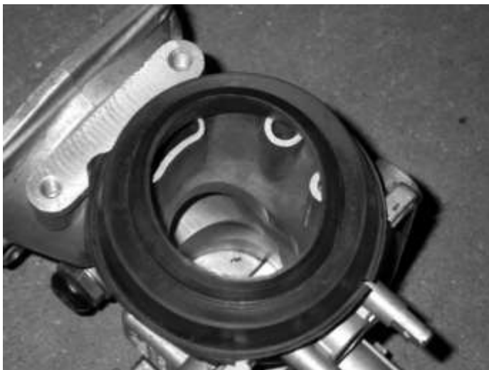
De Inlaatkanalen van de carburateurs worden gedeeltelijk afgedekt door de basis van imitatie K&N filters
