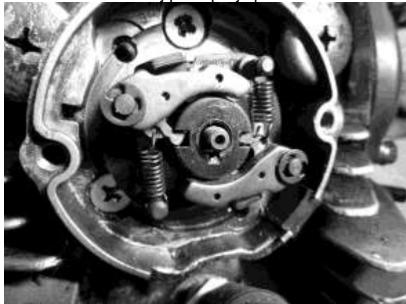
41.4A Druk de meenemer op zijn plaats, zorg ervoor dat de paspen in de as niet er uit valt
