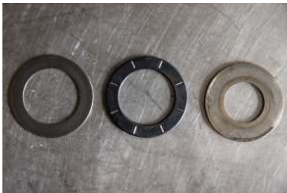
Aanvulling fig. 39.1D: v.l.n.r. ring, drukklager (3) en drukkring (4)
